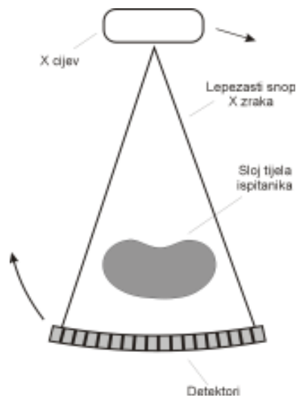
SLIKA 4.13 CT uređaj 3. generacije. Izvor odašilje lepezasti snop X zraka koji prolazi kroz ispitivani presjek tijela. Intenzitet propuštenih zraka mjeri se pomoću nekoliko tisuća malih detektora, koji čine kružni isječak. Tijekom snimanja jednog sloja izvor i detektor kruže oko njegovog središta. Nakon toga se ispitanik pomiče uzduž osi uređaja, te započinje snimanje sljedećeg paralelnog sloja. Podaci se šalju u računalo koje rekonstruira slike.
