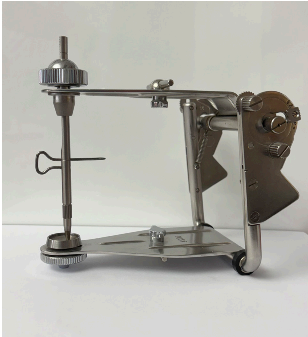
Slika 10. Non arcon Gerber artikulator (ljubaznošću doc. dr. sc. Nikoline Lešić, dr. med. dent).
