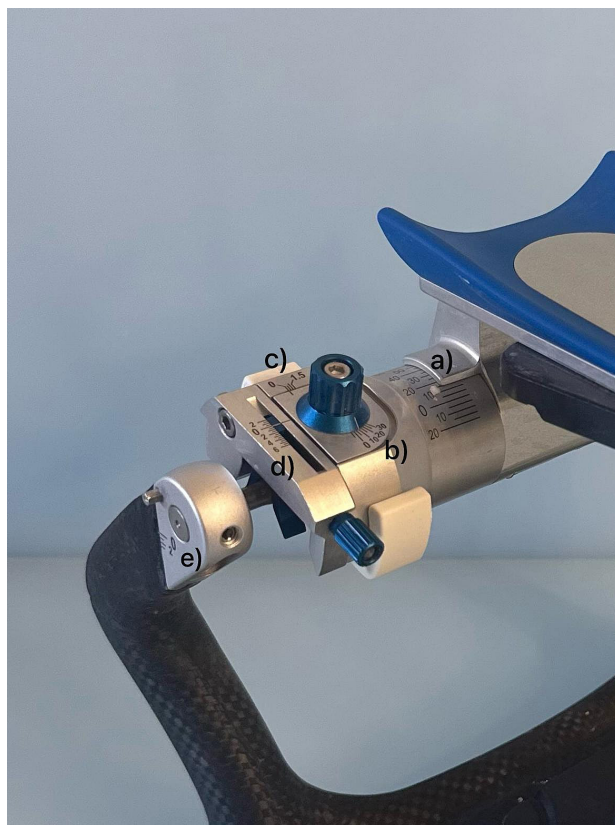
Slika 6. Mehanički zglob artikulatora a) skala za očitavanje vrijednosti nagiba kondilne staze, b) skala za očitavanje vrijednosti Bennetovog kuta, c) skala za očitavanje vrijednosti imedijatnog bočnog pomaka, d) skala za očitavanje protruzije i retruzije e) distrakcija stlačenih zglobova čeljusti.
