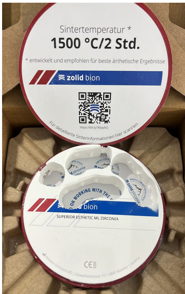
Slika 6. Blokovi višeslojne cirkonij-oksidge keramike (ljubaznošu izv. prof. dr. sc. Tee Galić, dr. med. dent.)
